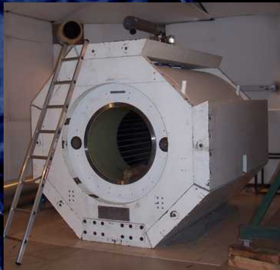
Aimant 3T blindé par ~20 tonnes d'acier
