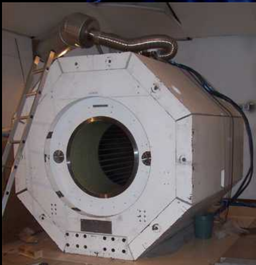
Aimant 3T blindé par ~20 tonnes d'acier
